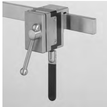
19799-05 Klemmsockel aus rostfreiem Stahl, für ein höhenverstellbares Stativ Ø 16 mm, elektrisch isoliert bis 4,5 kV AC, Spannweite 50 mm für Schienen 25/32 x 8/12 mm. Clamp socket made of stainless steel, for height-adjustable stand Ø 16 mm, electrically insulated up to 4.5 kV AC, holding width of 50 mm for rails 25/32 x 8/12 mm.
